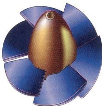
Rodete de una turbina Kaplan
